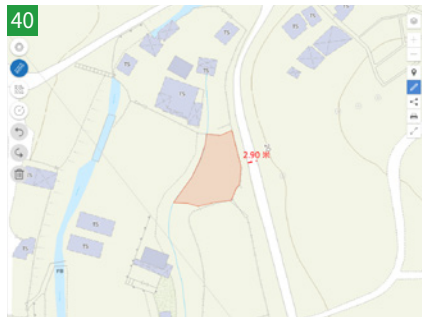
圖 40：利用「地理資訊地圖」量度車輛通道闊度的方法（「地理資訊地圖」截圖）
